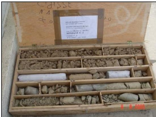
Prove geotecniche di laboratorio : carotaggi
